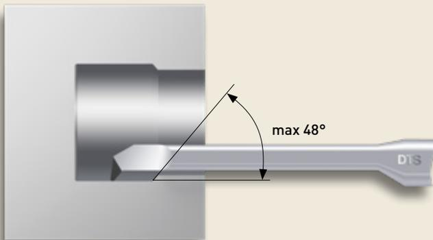
CVD / CBN Bohrstangen für das Drehen von zylindrischen Bohrungen, Freistichen und nach hinten größer werdenden Durchmessern.
