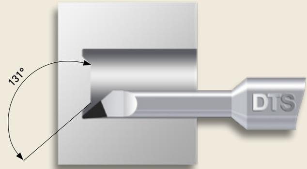
CVD/CBN Bohrstangen für das Drehen von Konturen an der Planfläche.
