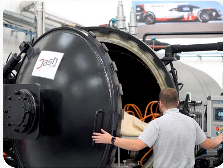
3x Autoclaves (Largest 1.65m Dia x 4m)
